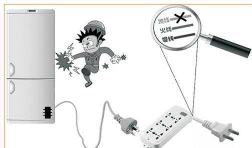
“两芯线插座”的触电事故示意图
